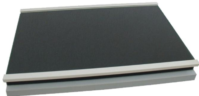
Kontaktrahmen fixieren durch ihre Andruckscheibe das Layout auf der fotoempfindlichen Schicht der Platine. Somit wird ein verrutschen der Vorlage während der Belichtung verhindert. Kontaktrahmen bestehen aus einer stabilen, Kunststoff beschichteten Holzfaserverplatte mit einer 22mm dicken Schaumstoffauflage. Die Andruckscheibe (6 mm) ermöglicht eine Belichtungsfläche von 420 x 260 mm.
